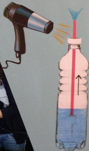
Con l'aumentare della temperatura l'aria che si riscalda si dilata, diventa meno densa (e quindi più leggera) e la pressione atmosferica diminuisce. In questo caso l'aria calda del phon riscalda quella circostante provocando una diminuzione della pressione all'interno della cammuccia e a causa di questa diminuzione l'acqua sale attraverso la
